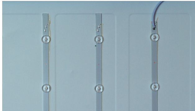
Рассеивающие линзы на светодиодах обеспечивают равномерное световое свечение.
